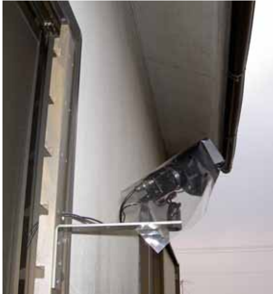
図5 窓枠への設置例
